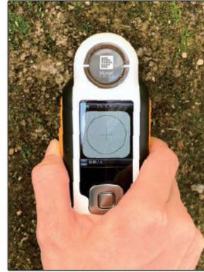
レンズ部を密着させ測定するので、晴れや雨などの天候に左右されず対象物の色そのものを測定できます。
