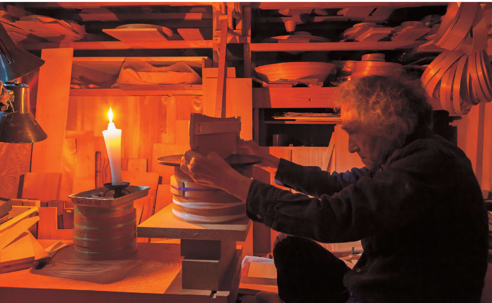
大西勲 曲輪造さゆう漆の漆芸家で人間国宝の大西勲氏。和燭燭のあかりの漏れ具合を見ながら、真弧の刃を隙間なく合わせていく。
