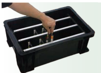
④ 基板を差し込んでいく
