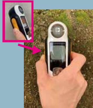
側面の測定ボタンを半押しし、液晶画面で照準を確認します
